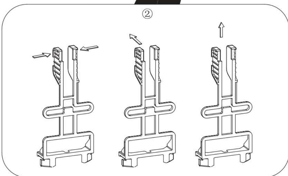
Entfernen Sie den Hebel
