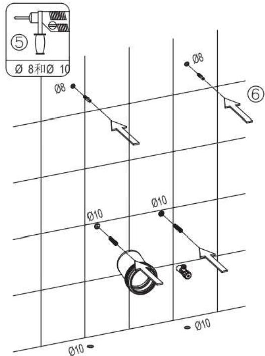
Bohren Sie die Löcher gemäß den markierten Punkten (die Bohrtiefe muss größer sein als die Länge des DüBELS, und der Durchmesser ist in der Abbildung angegeben), setzen Sie anschließend die entsprechenden DüBEL in die Löcher ein
