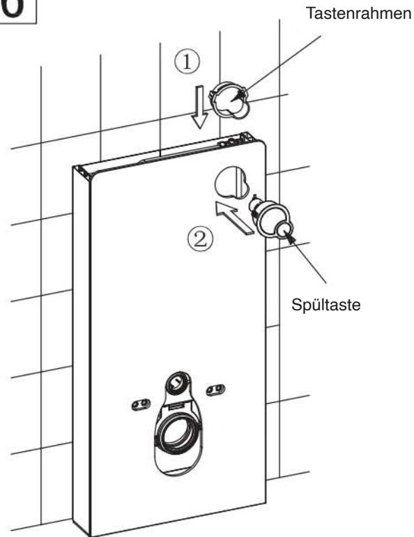
Montieren Sie den Tastenrahmen und die Spültaste auf der Glasplatte
