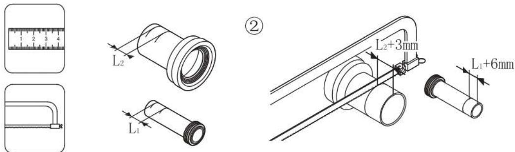
Schneiden Sie das Spülrohr und das Abflussrohr ab
