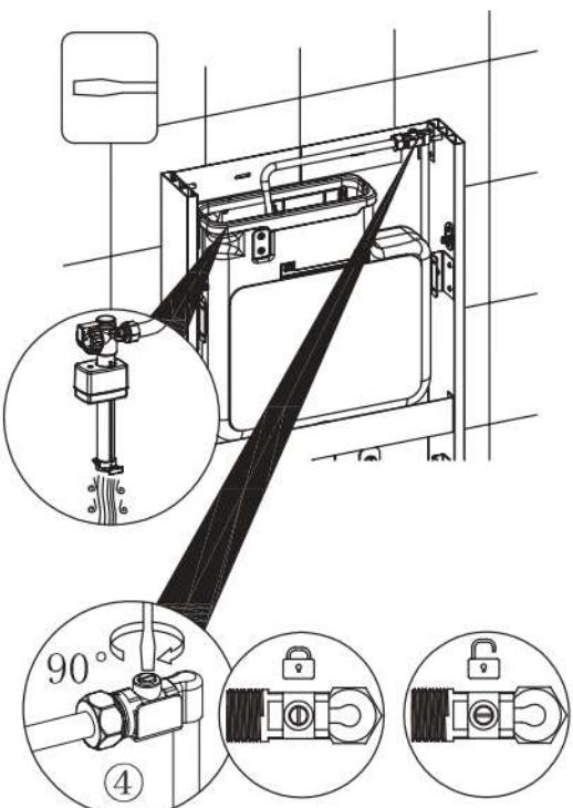
Stellen Sie das Ventil am Schlauch auf die geöffnete Position und überprüfen Sie den Wasserzulauf in den Spülkasten
