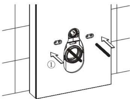
Schrauben Sie die Schrauben in den Rahmen des Spülkastens
