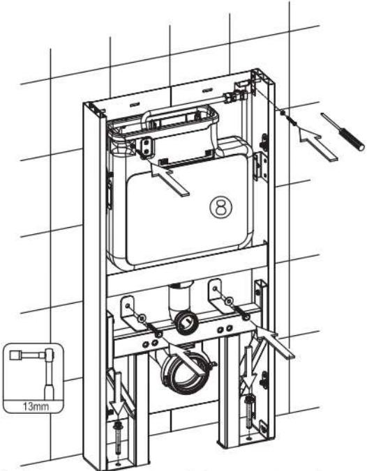
Schrauben Sie die passenden Schrauben in die Wanddübel und in die Stahlspreizbolzen im Boden
