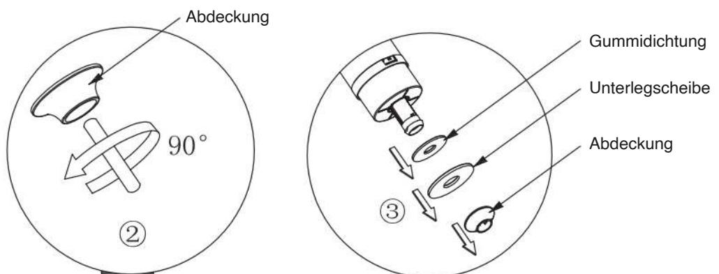
Entfernen Sie die Abdeckung, Unterlegscheibe und Gummidichtung, indem Sie die Abdeckung etwa 90° gegen den Uhrzeigersinn drehen
