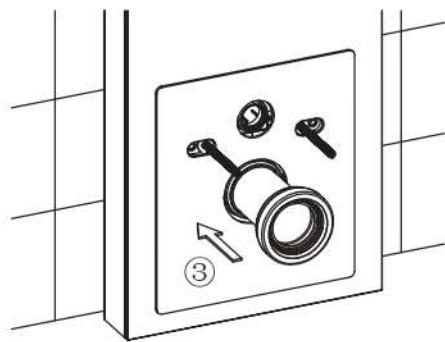
Installieren Sie das gerade Spülrohr im Spülkasten
