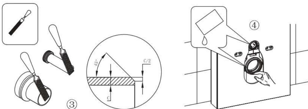
Schleifen Sie die Kanten des Spülrohrs und des Abflussrohrs ab, um eine Fase zu erzeugen
