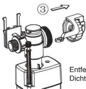
Entfernen Sie das Dichtungselement (Absperreteil)
