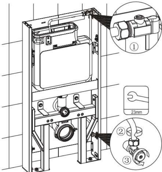
Befestigen Sie den Schlauch wieder an der Halterung und schließen Sie ihn an das Absperrventil in der Wand an
