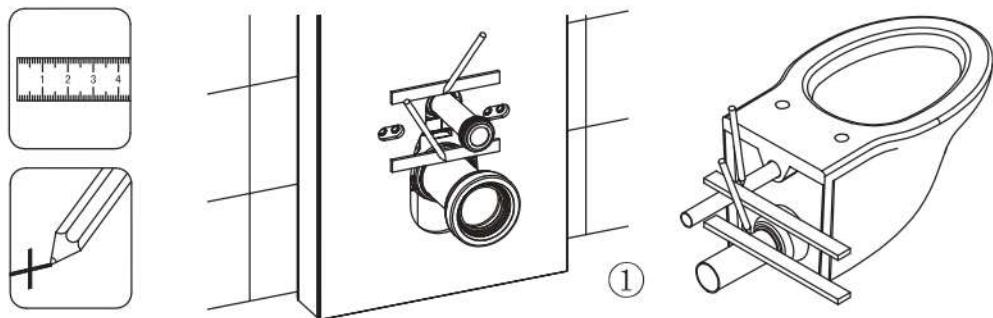
Markieren Sie das gerade Spülrohr und das Abflussrohr
