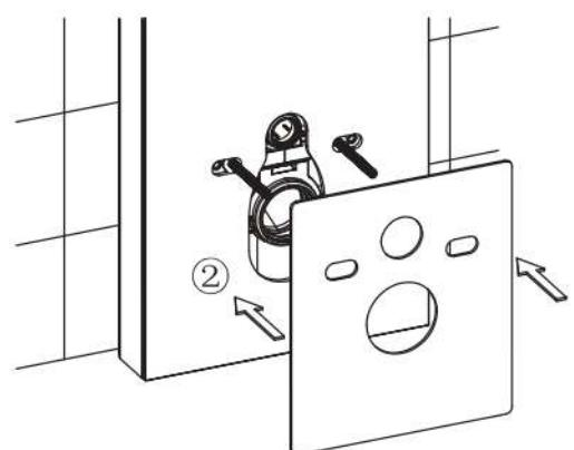
Installieren Sie die Schalldämmplatte unter der Toilette
