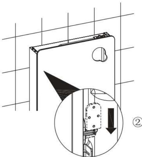
Installieren Sie die Platte, achten Sie darauf, dass die Glasplatte eng am Aluminiumrahmen anliegt, und drücken Sie die Platte dann nach unten, bis die Aufhängehaken vollständig in den Befestigungen am Rahmen eingerastet sind
