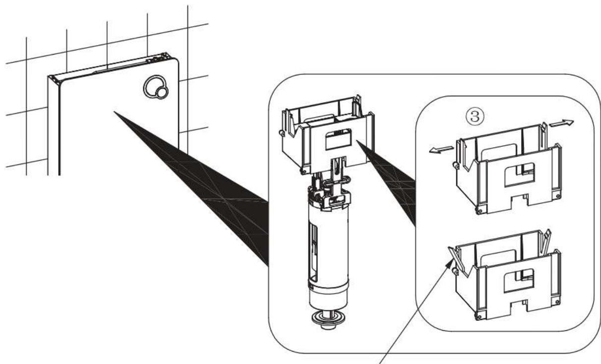
Öffnen Sie die Verschlüsse an der Aufhängeplatte des Spülkastens und heben Sie das Spülventil nach oben heraus
