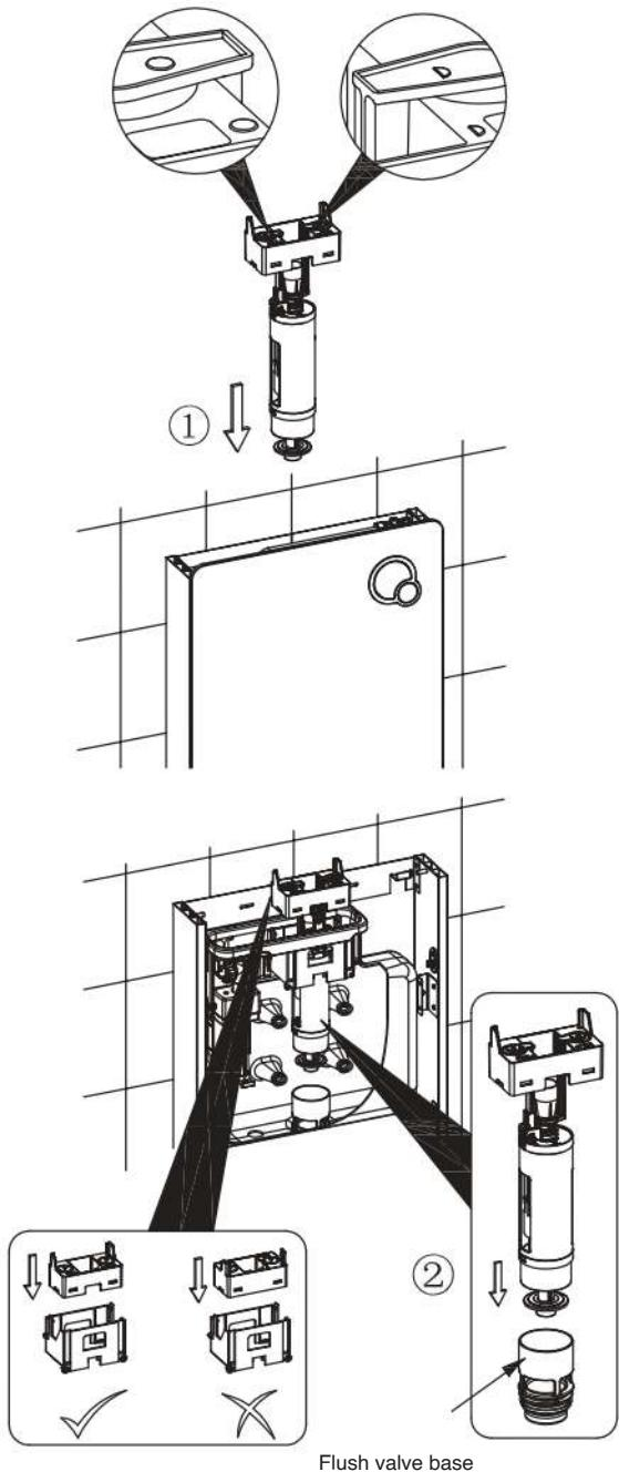
Installieren Sie das Spülventil nach unten in den Spülkastenkörper. Hinweis: Achten Sie darauf, dass die Unterseite des Ventils mit der Spülventilbasis ausgerichtet ist. Stellen Sie sicher, dass das Ventil in der in der Abbildung gezeigten Richtung eingebaut wird.
